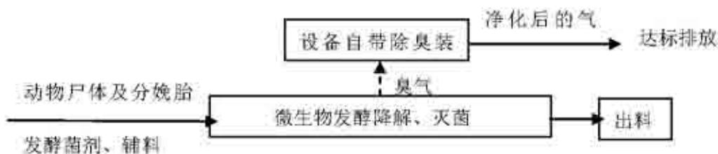
图 2-4 高温生物降解机工艺流程及产污环节图
