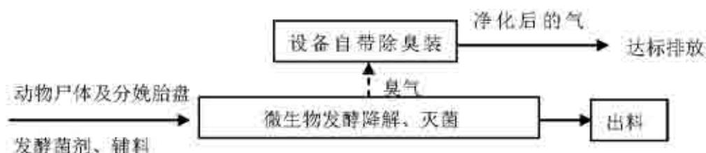
图 2-11 高温生物降解机工艺流程及产污环节图
